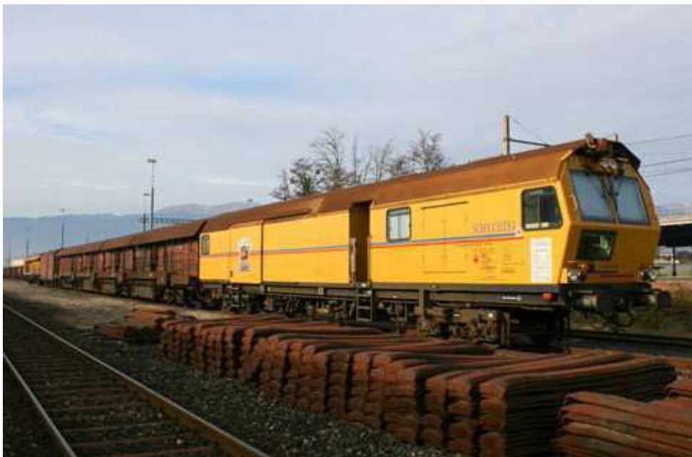
Train meuleur de rails (Scheuchzer S.A.)
